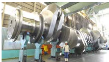
船舶用の超大型「組立型クランク軸」。
