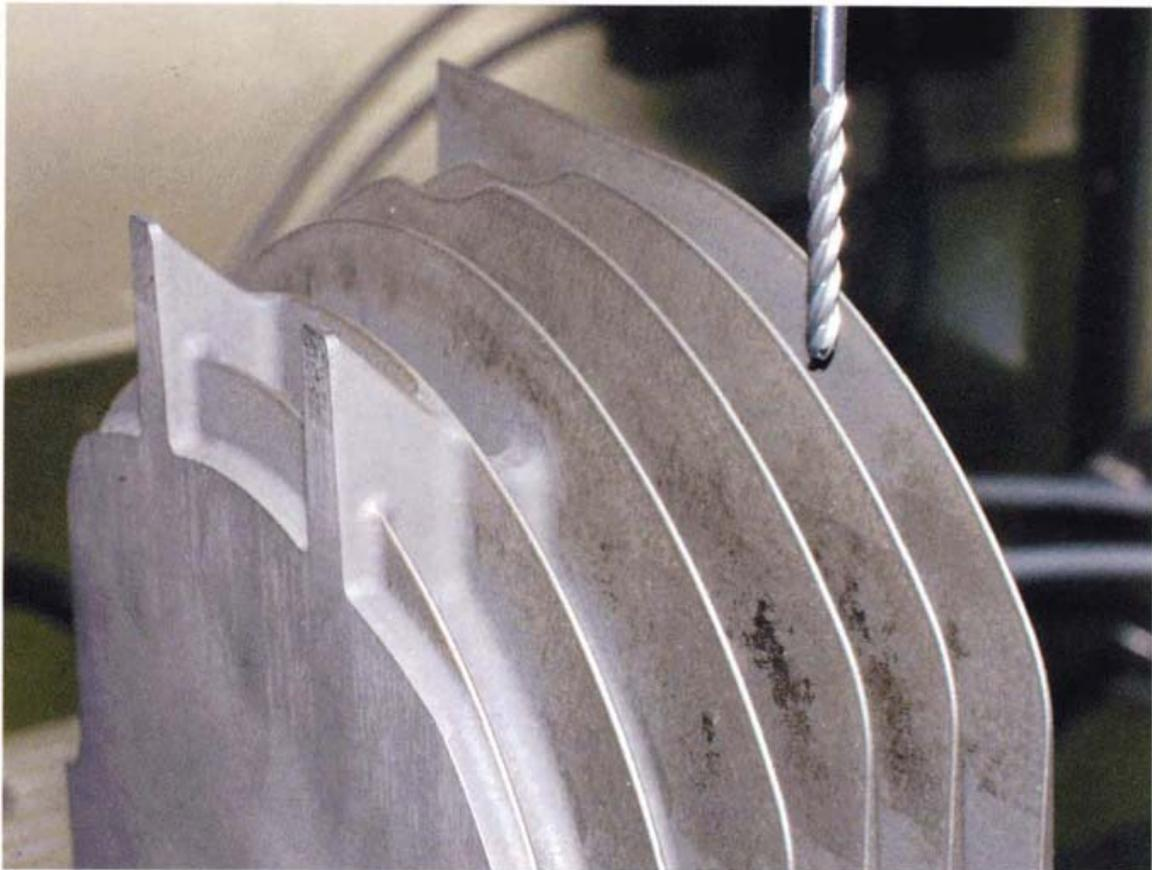
一定のチップ負荷を維持する送り速度の最適化を使うと、Delaware Machinery では非常に薄いフィンの電極を加工しても損傷の可能性が極めて少ない
