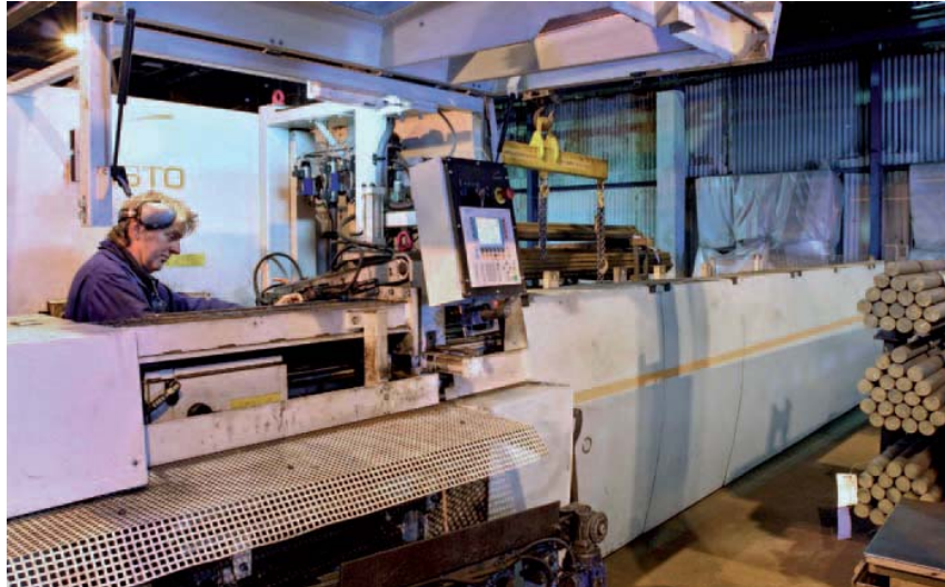
Cooper and Turner は、風力エネルギー関連で、Kasto の鋸技術を使い、ファスナーを正確な長さに切断する
