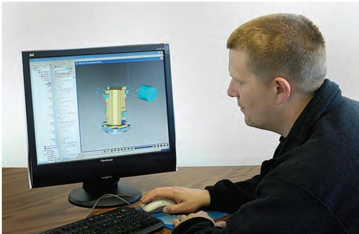
Hydraforce で横型マシニングセンターのプログラムを作る Brian Daavettilla は、NC 検証ソフトウェア、ベリカットを使い、油圧マニホールドブロックの機械加工プログラムを検証している。
